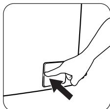
Закройте дверцу фильтра сливного насоса.
