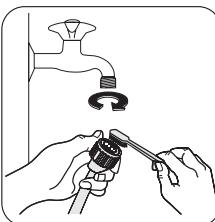
Закройте кран подачи воды. Отвинтите наливной шланг. Прочистите фильтр жесткой щеткой. Привинтите на место наливной шланг.
